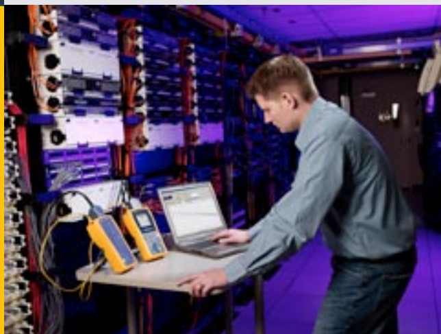
DTX-1800 et kit DTX 10 Gbit/s pour le test des performances de la diaphonie exogène
